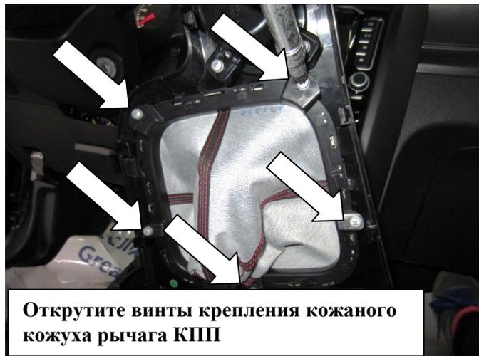
Открутите винты крепления кожаного кожуха рычага КПП
