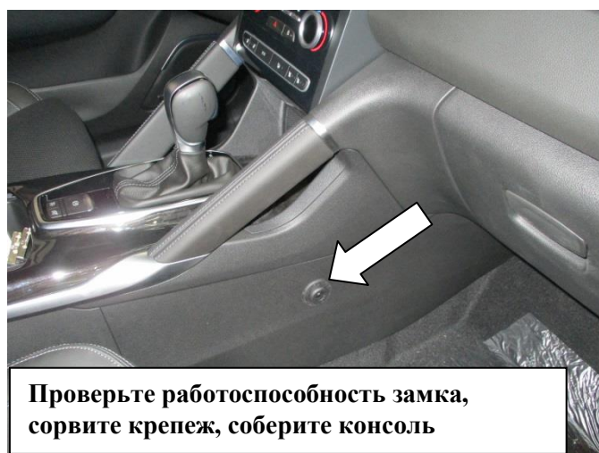
Удалите часть пластика в консоли под корпус замка. Установите шаблон SCH7 на корпус замка
