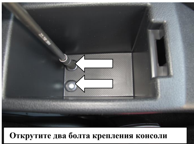
Снимите накладку консоли
