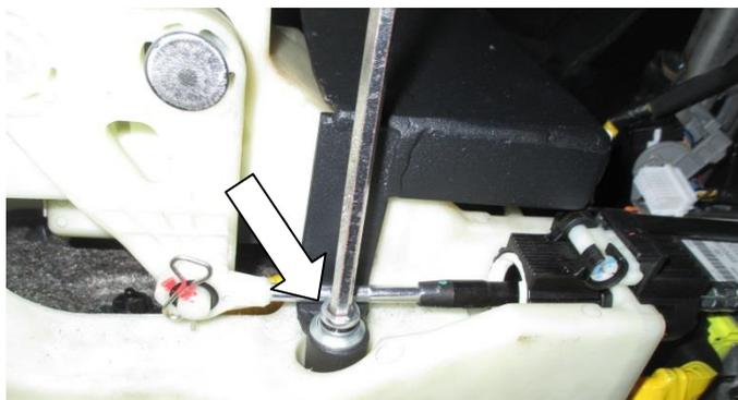
Установите кронштейн (поз. 3), закрепив болтом (поз. 7) с шайбой (поз. 9).
