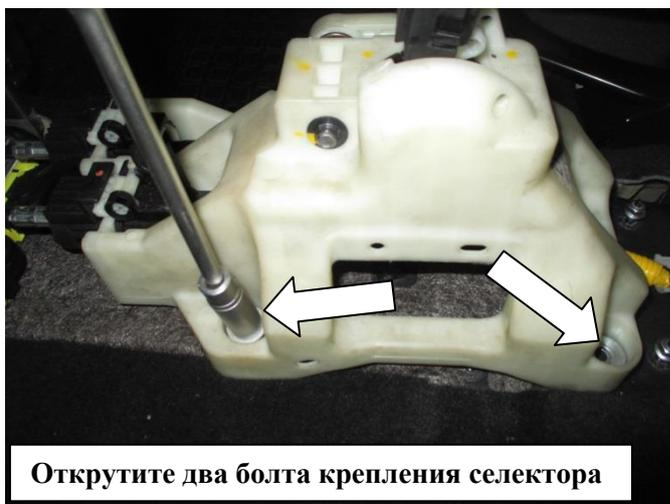
Открутите два болта крепления селектора
