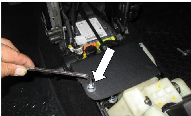
Закрепите кронштейн (поз. 3) болтом (поз. 6) с шайбой (поз. 9)
