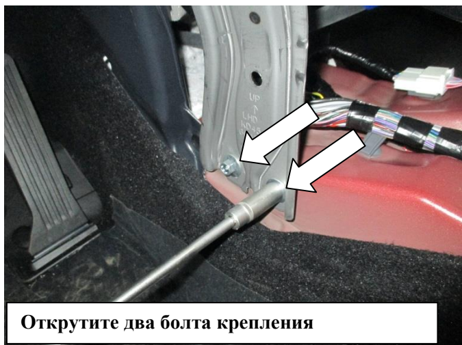
Открутите болт крепления селектора
