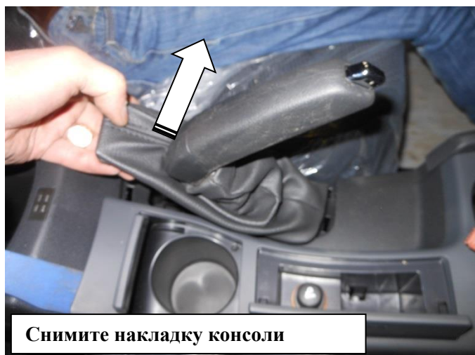
Снимите накладку консоли. Открутите винт крепления консоли
