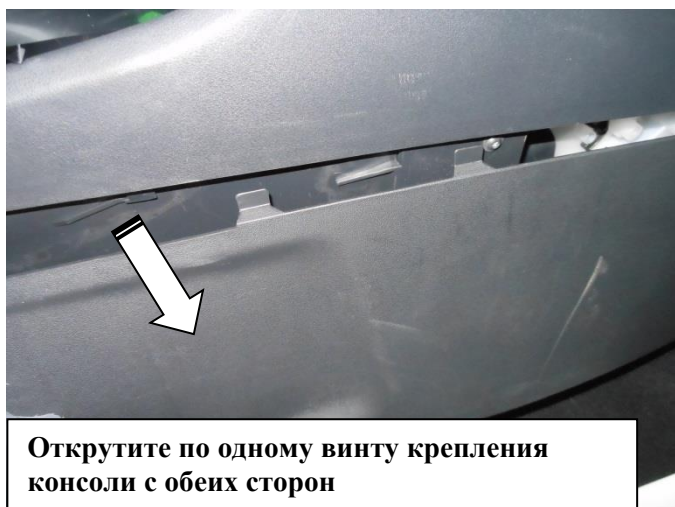
Открутите два винта крепления консоли. Снимите накладку консоли
