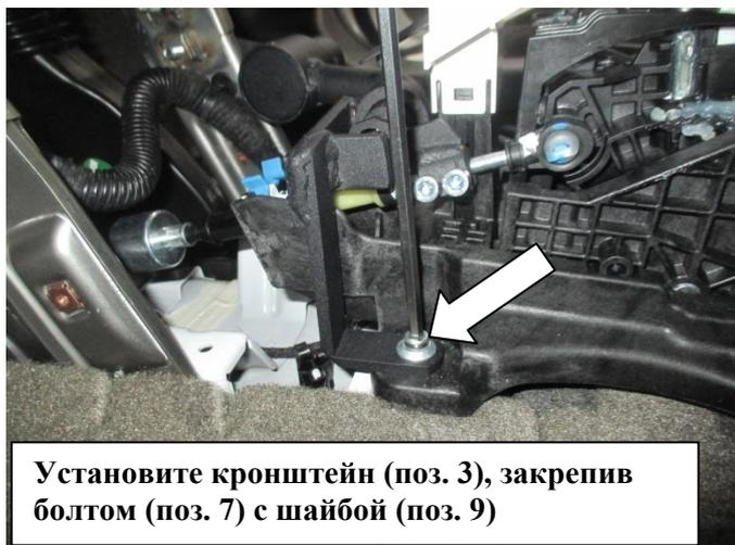
Установите кронштейн (поз. 3), закрепив болтом (поз. 7) с шайбой (поз. 9)
