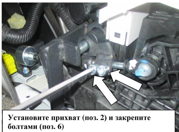
Установите прихват (поз. 2) и закрепите болтами (поз. 6)
