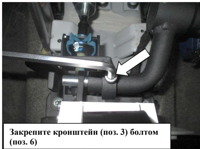
Закрепите кронштейн (поз. 3) болтом (поз. 6)
