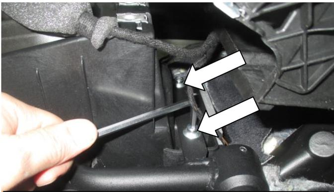
Установите замок (поз. 1) и закрепите передние точки крепления болтами (поз. 5) с шайбами (поз. 7)
