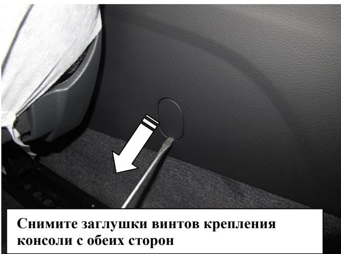
**Снимите заглушки винтов крепления консоли с обеих сторон**
