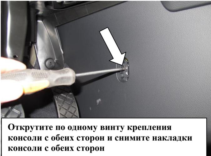
**Открутите по одному винту крепления консоли с обеих сторон и снимите накладки консоли с обеих сторон**
