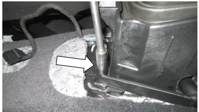
Закрепите заднюю точку крепления замка (поз. 1) гайкой (поз. 6)
