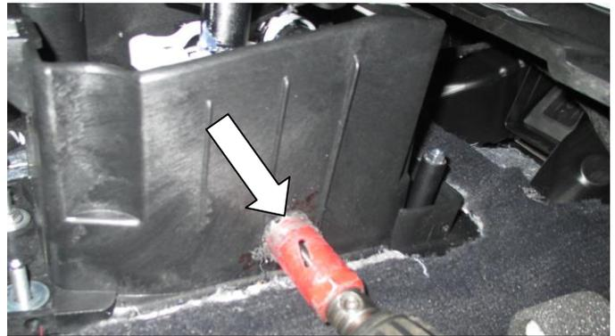
Приложите замок (поз. 1) по посадочным местам, разметьте и просверлите отверстие Ø22 мм в стенке селектора
