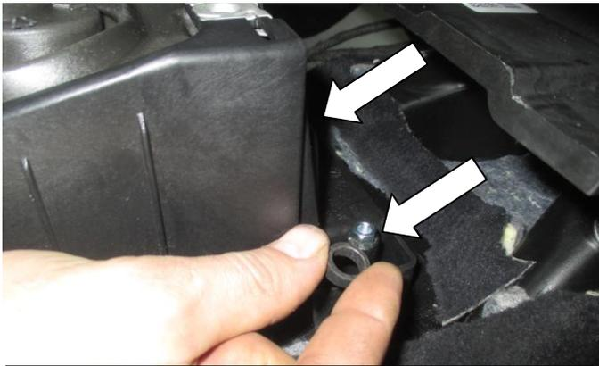
Установите проставки (поз. 3) поверх проставок (поз. 2)
