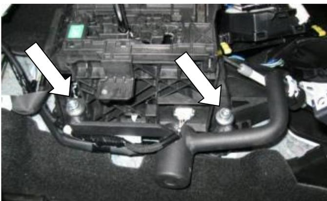
Установите замок (поз. 1) и закрепите болтами (поз. 6, 8) с шайбами (поз. 9)
