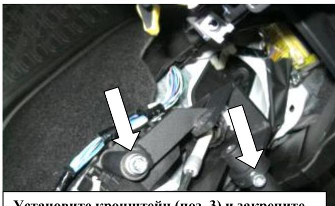
Установите кронштейн (поз. 3) и закрепите болтом (поз. 7) с шайбой (поз. 9) и болтом (поз. 5)
