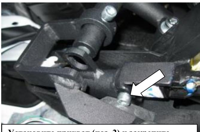
Установите прихват (поз. 2) и закрепите болтом (поз. 5)
