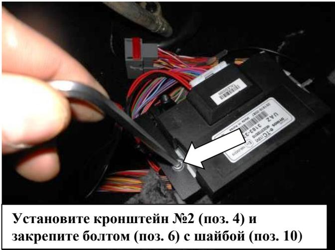
Установите кронштейн №2 (поз. 4) и закрепите болтом (поз. 6) с шайбой (поз. 10)
