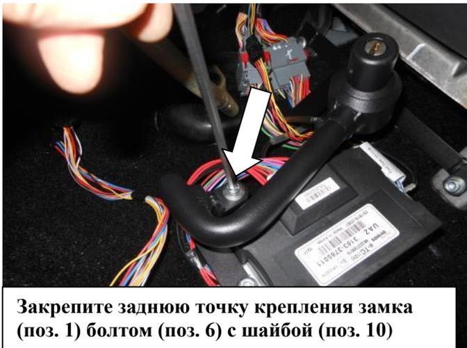
Закрепите заднюю точку крепления замка (поз. 1) болтом (поз. 6) с шайбой (поз. 10)
