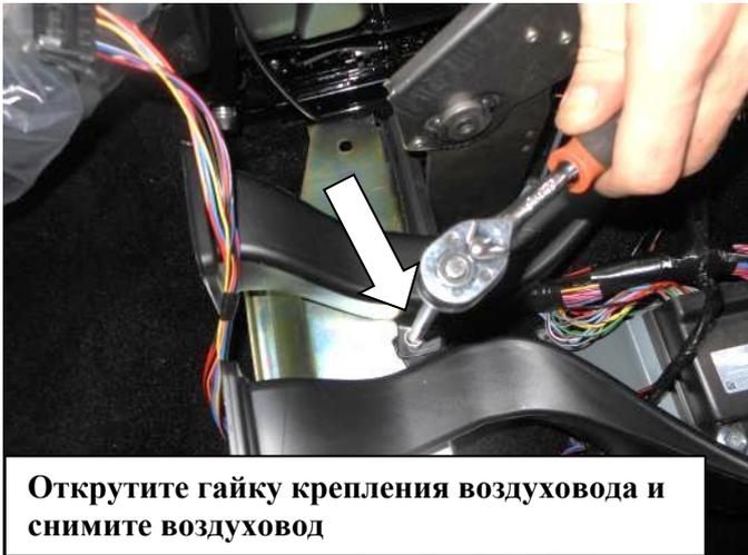
Открутите гайку крепления воздуховода и снимите воздуховод
