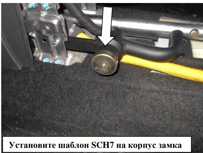
Разметьте и просверлите отверстие под корпус замка ф32 мм
