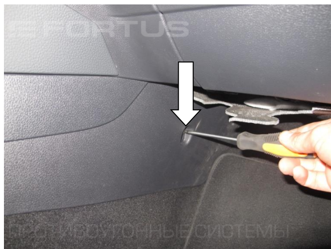
4. Открутите по одному винту крепления консоли с обеих сторон. Снимите накладки консоли с обеих сторон
