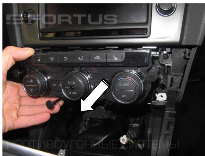
10. Извлеките пистоны крепления электронного блока. Снимите электронный блок
