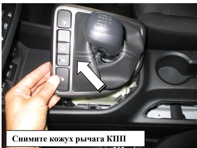
Снимите кожану рычага КПП
