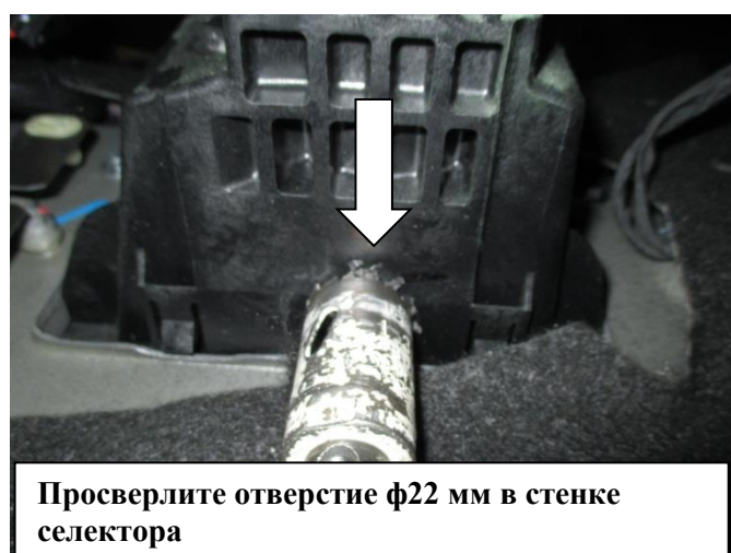
Разметьте место сверления селектора (от ребра селектора 60мм)
