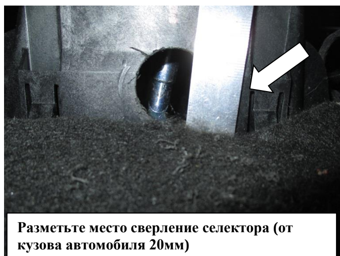
Просверлите отверстие ф22 мм в стенке селектора
