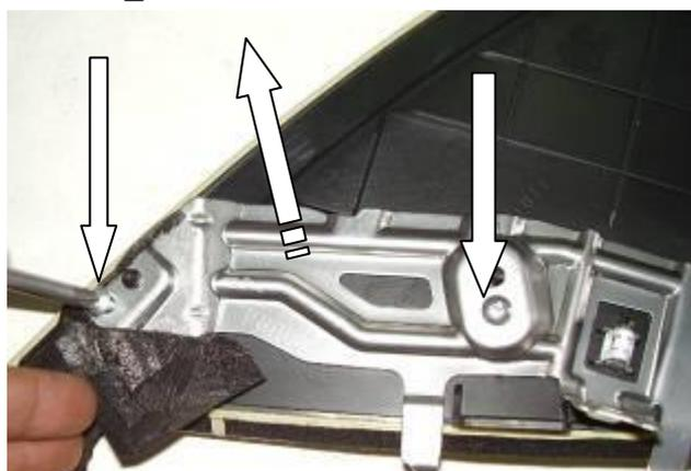
Открутить 2 самореза, снять держатель консоли
