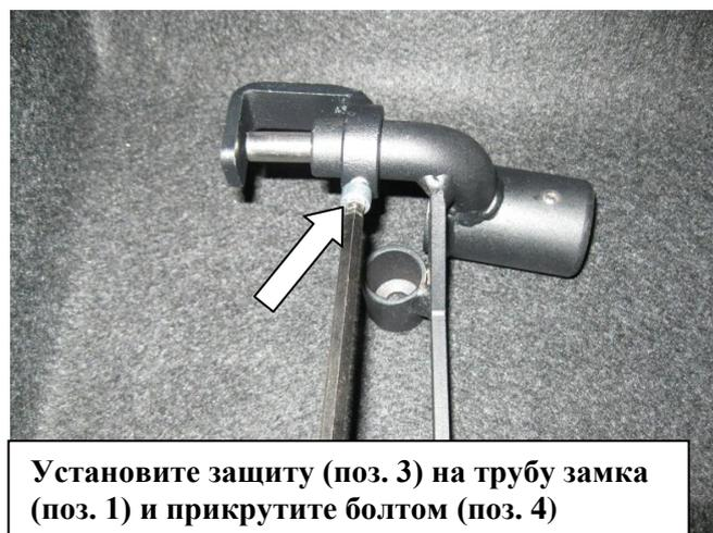
Установите защиту (поз. 3) на трубу замка (поз. 1) и прикрутите болтом (поз. 4)
