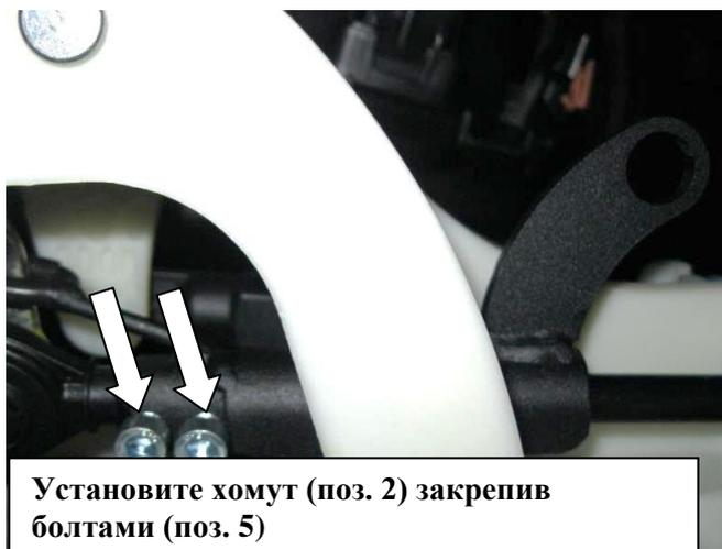
Установите хомут (поз. 2) закрепив болтами (поз. 5)
