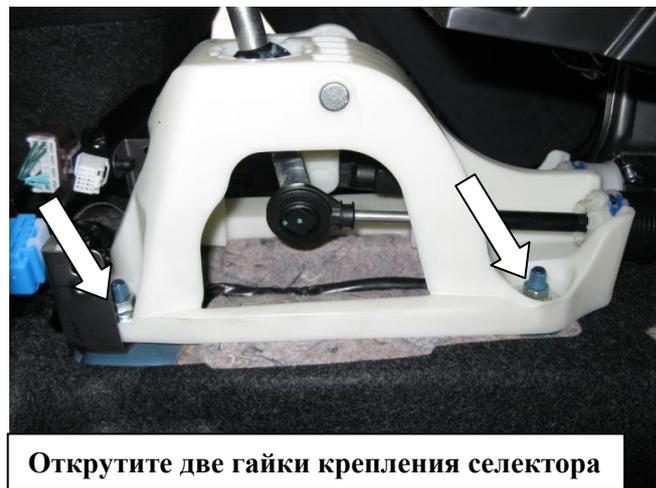
Открутите две гайки крепления селектора
