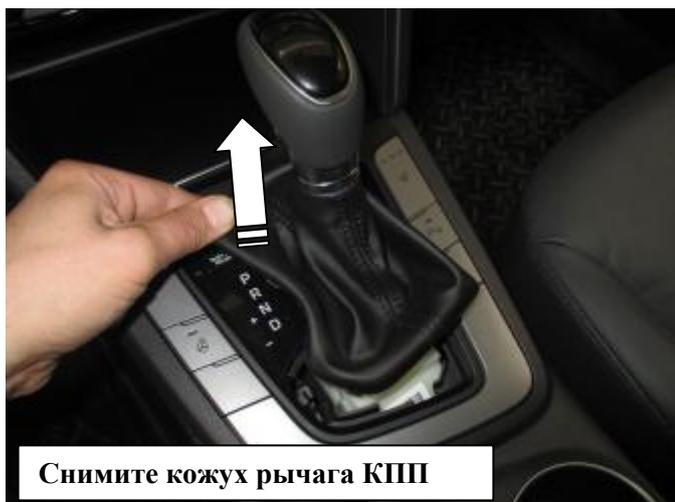
**Снимите кожух рычага КПП**
