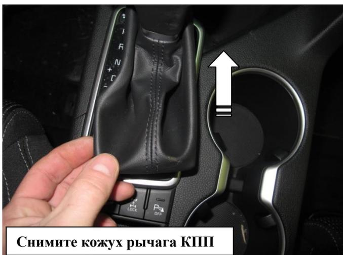
Снимите кожух рычага КПП
