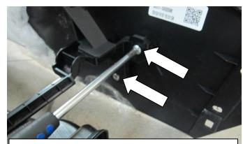
Открутите два винта крепления боковой консоли, после установки шаблона и разметки, закрутите обратно
