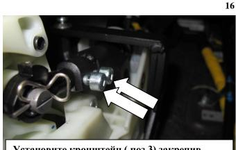
Установите кронштейн ( поз.3) закрепив винтами ( поз.7,9) с шайбами ( поз.10 11)
