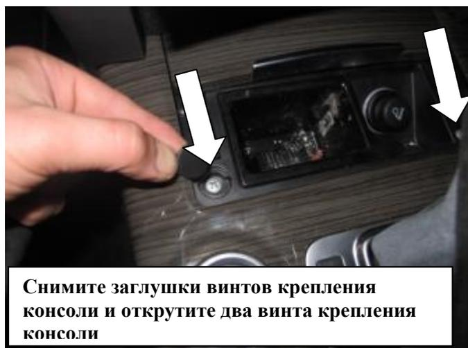
Снимите заглушки винтов крепления консоли и открутите два винта крепления консоли
