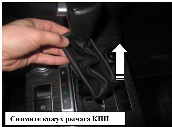
Снимите кожух рычага КПП
