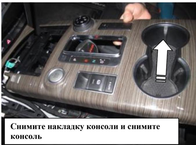
Снимите накладку консоли и снимите консоль
