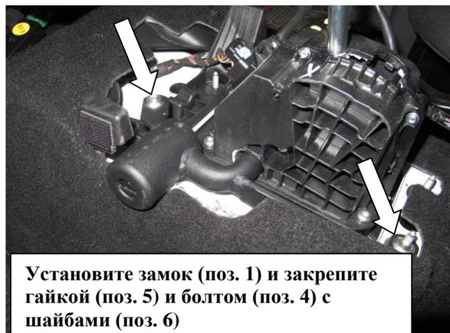
Установите замок (поз. 1) и закрепите гайкой (поз. 5) и болтом (поз. 4) с шайбами (поз. 6)
