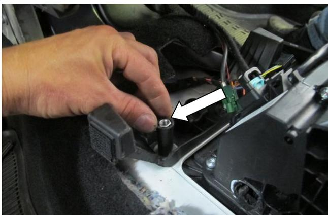
Установите деталь (поз. 3) на деталь (поз. 2)
