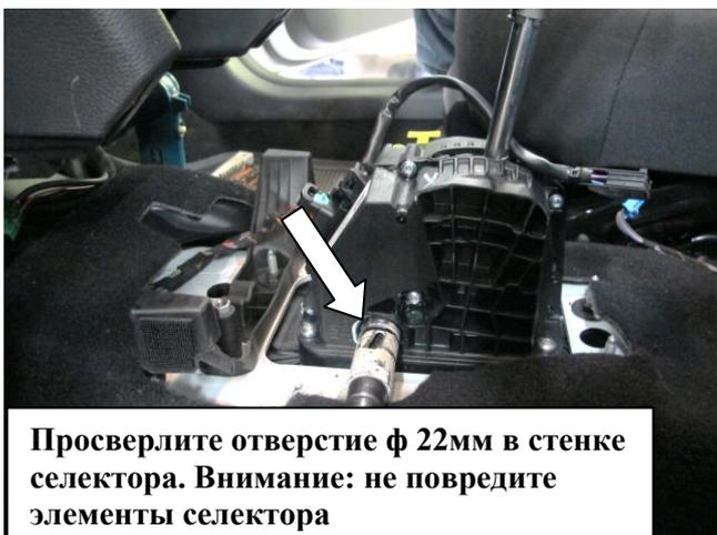
Просверлите отверстие ф 22мм в стенке селектора. Внимание: не повредите элементы селектора
