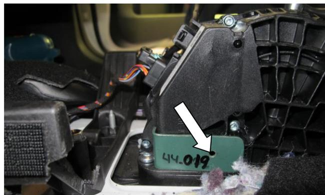
Установите разметочный шаблон 44.019 и разметьте место сверления отверстия
