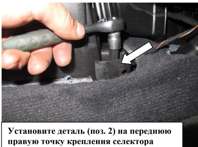
Установите деталь (поз. 2) на переднюю правую точку крепления селектора
