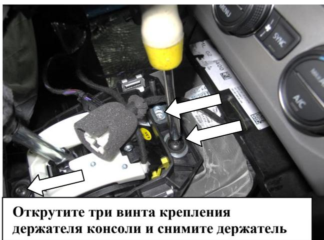
Открутите три винта крепления держателя консоли и снимите держатель
