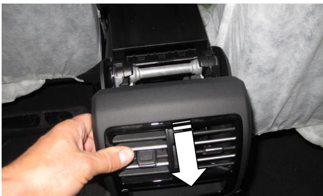
Снимите накладку консоли и открутите два винта крепления консоли
