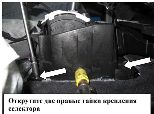
Открутите две правые гайки крепления селектора
