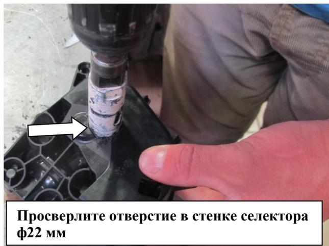
Просверлите отверстие в стенке селектора
