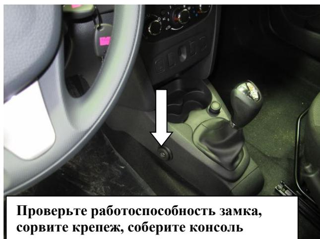
Проверьте работоспособность замка,
