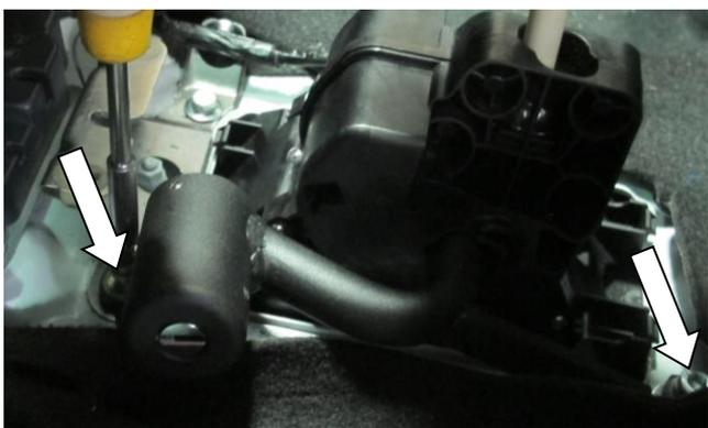
Установите замок (поз. 1) закрепив болтами
