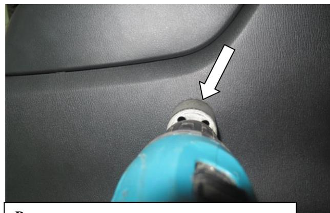
Разметьте и просверлите отверстие под корпус замка ф32 мм.
