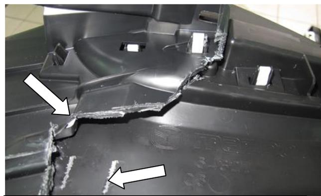
Подрежьте ребро консоли в месте касания замка
