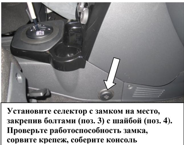
Установите селектор с замком на место, закрепив болтами (поз. 3) с шайбой (поз. 4). Проверьте работоспособность замка, сорвите крепеж, соберите консоль
