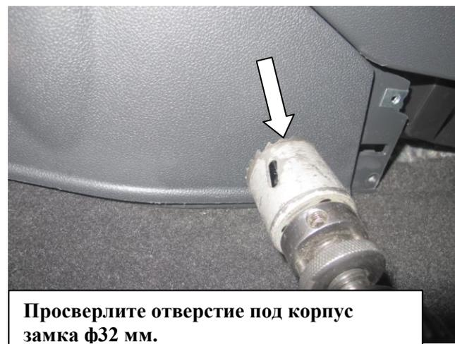
Просверлите отверстие под корпус замка ф32 мм.
