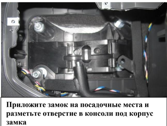
Приложите замок на посадочные места и разметьте отверстие в консоли под корпус замка
