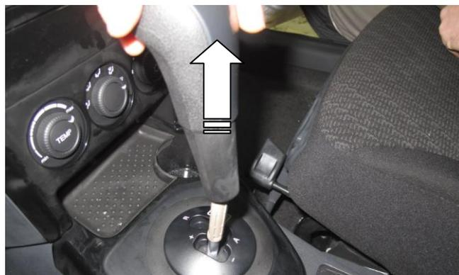
Снимите рукоятку рычага переключения передач КПП
