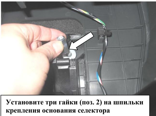
Установите три гайки (поз. 2) на шпильки крепления основания селектора
