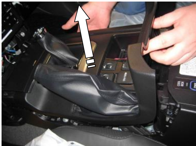
Снять рукоятку рычага переключения передач, верхнюю крышку
