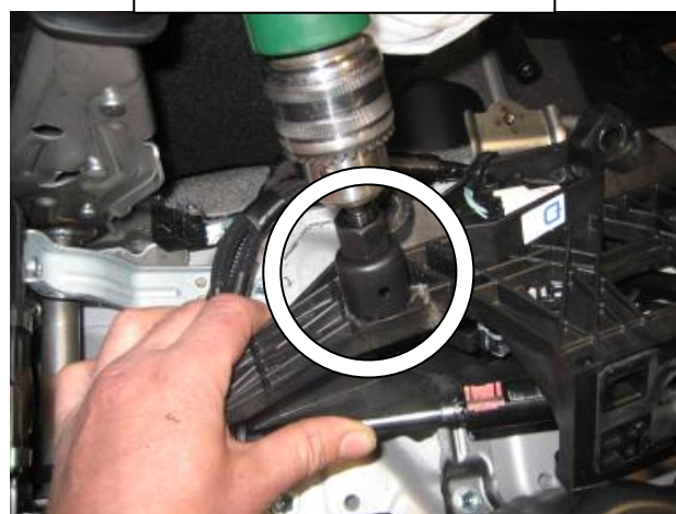
Просверлить отверстие в селекторе под трубу замка
