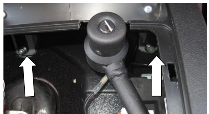
Закрепите передние точки крепления замка (поз. 1) винтами (поз. 9) с шайбами (поз. 13)
