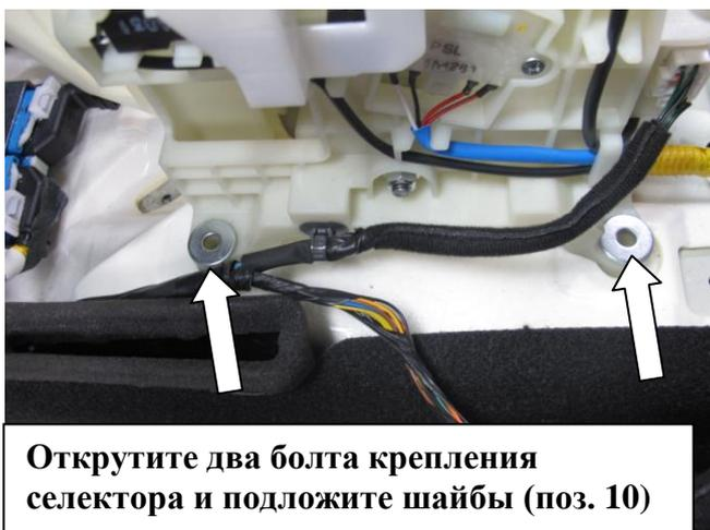
Открутите два болта крепления селектора и подложите шайбы (поз. 10)
