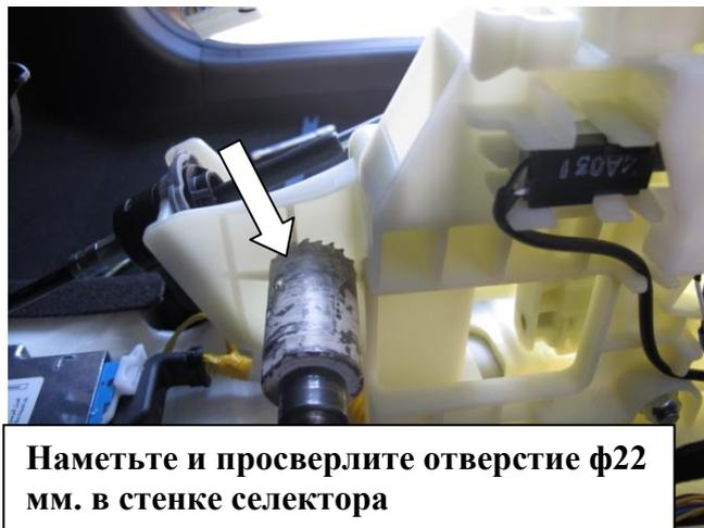
Наметьте и просверлите отверстие ф22 мм. в стенке селектора
