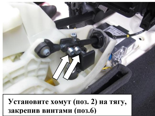
Установите хомут (поз. 2) на тягу, закрепив винтами (поз.6)
