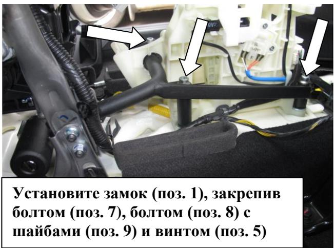
Установите замок (поз. 1), закрепив болтом (поз. 7), болтом (поз. 8) с шайбами (поз. 9) и винтом (поз. 5)
