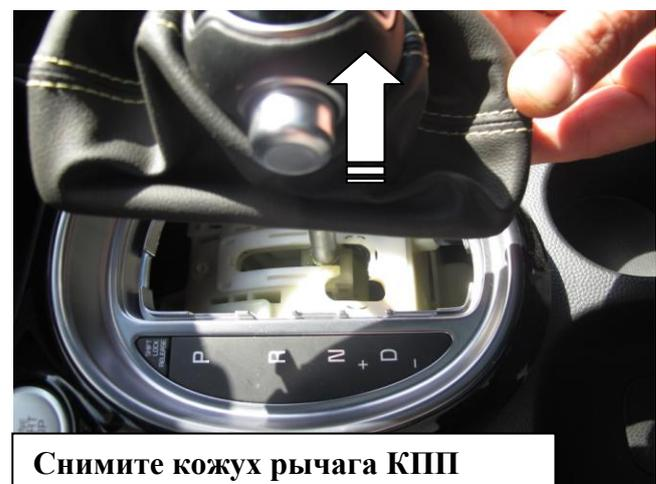
Снимите кожух рычага КПП
