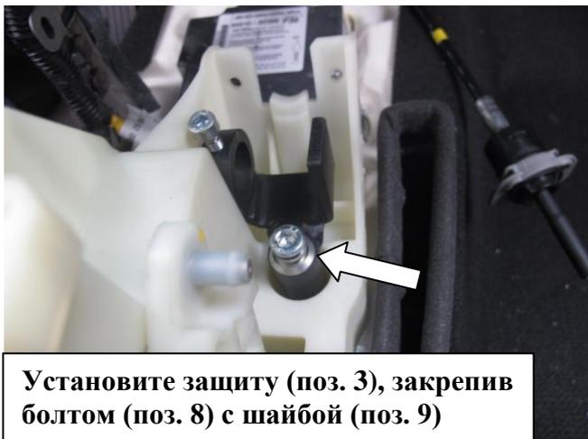
Установите защиту (поз. 3), закрепив болтом (поз. 8) с шайбой (поз. 9)
