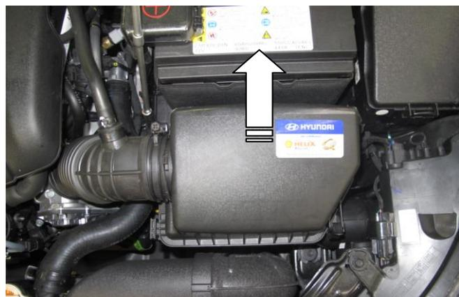
Демонтируйте корпус воздушного фильтра
