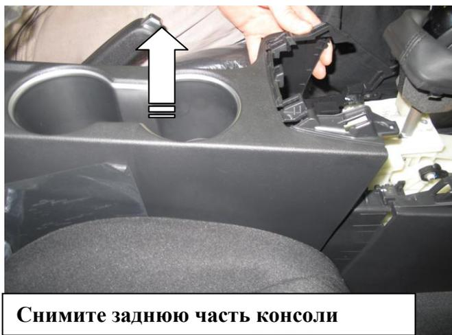
**Снимите заднюю часть консоли**
