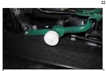
Установите шаблон на замок, разметьте отверстие в консоли
