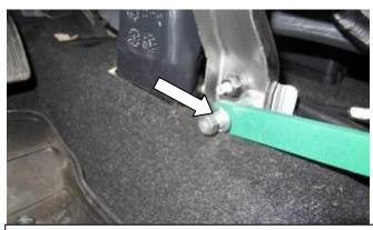
Установите замок, зафиксируйте переднюю точку крепления, крепеж не срывать
