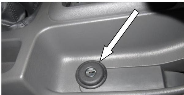
Разметьте отверстие в консоли под корпус замка. Просверлите отверстие ф 32 мм. Соберите консоль.
