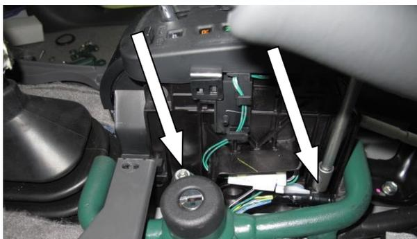
Установите замок поз.1 на штатные места крепления селектора.
