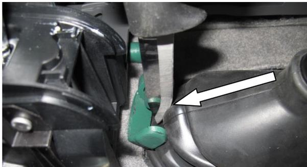
Сделайте надрез в пыльнике рычага раздаточной коробки передач и проденьте в него хомут.
