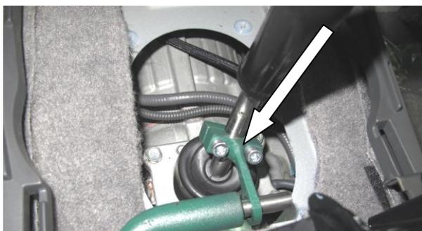
Установите хомут поз.3 и кронштейн поз.4 на рычаг раздаточной коробки передач. Блокировка в положении «4Н»
