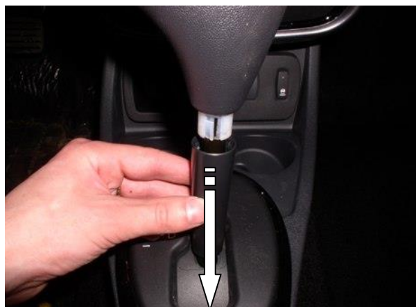
Снять декоративный колпак рукоятки рычага переключения передач
