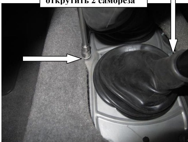
Открутить 2 штатных болта селектора
