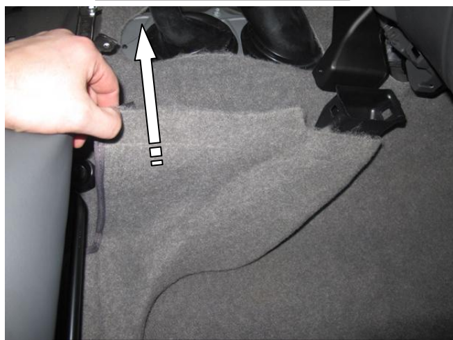
Снять консоль и звукоизоляцию
