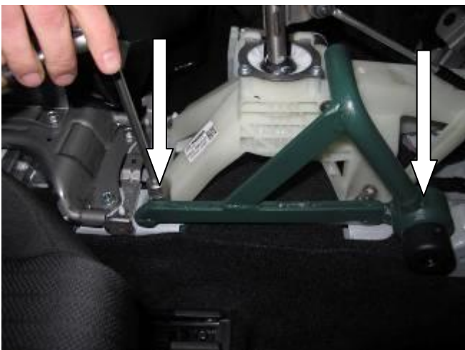
Установить замок на шпильки, закрутить 2 срывные гайки
