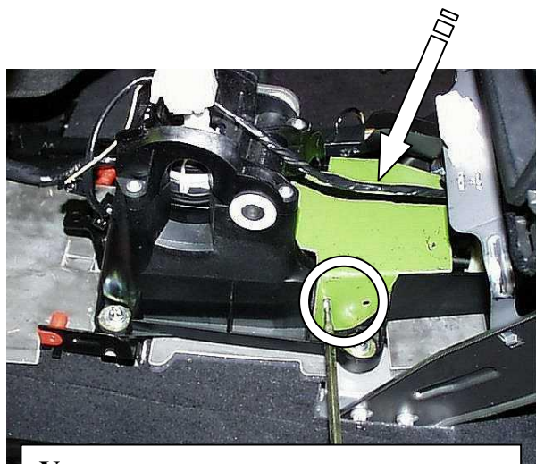
Установить защиту на селектор, просверлить крепёжные отверстия сквозь отверстия в защите
