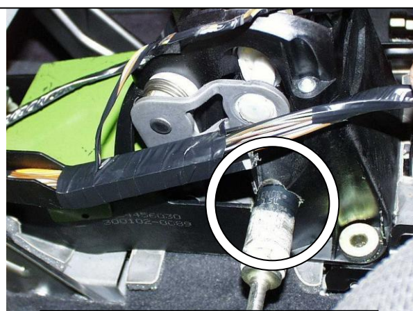
19 Просверлить отверстие 22 мм. в селекторе под трубу замка 20
