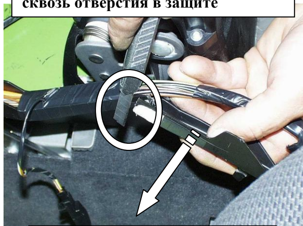
Удалить часть жёлоба кабеля, мешающую установке замка
