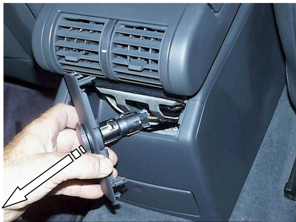
Снять крышку, разъединить разъём прикуривателя
