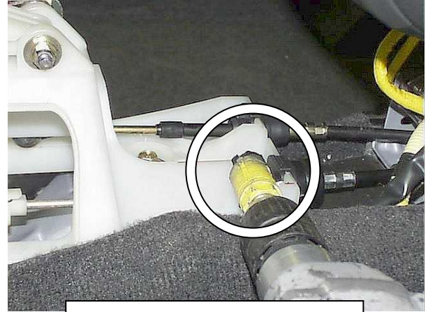
Просверлить отверстие в селекторе под трубу замка
