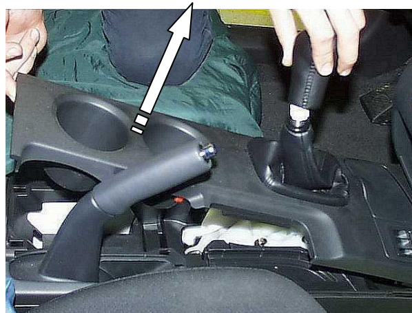
Снять верхнюю крышку
