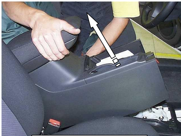
Снять заднюю консоль
