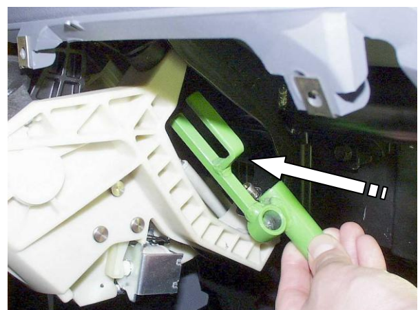
Установить хомут на тягу
