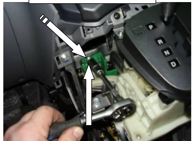
Установить деталь-переходник, зафиксировать срывным болтом
