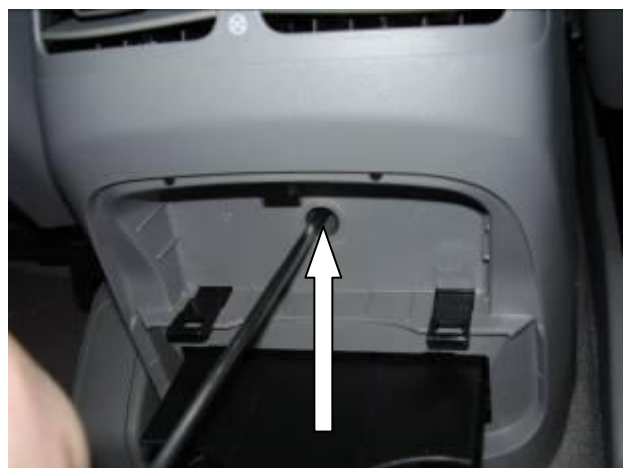
Открыть крышку, открутить саморез
