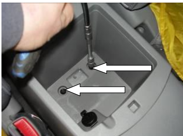
Поднять подлокотник, открутить 2 самореза
