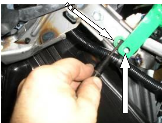
Подложить столбик 8 мм. под лапку замка, закрутить срывной болт
