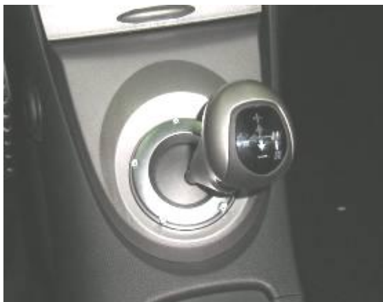
Положение рычага переключения передач для блокировки – «R»
