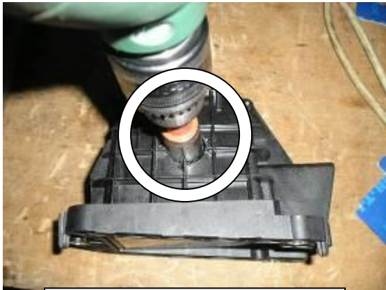
Просверлить отверстие в селекторе под трубу замка
