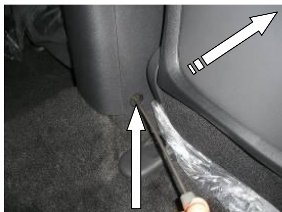
Сдвинуть передние сидения до упора вперёд, открутить саморезы с обеих сторон
