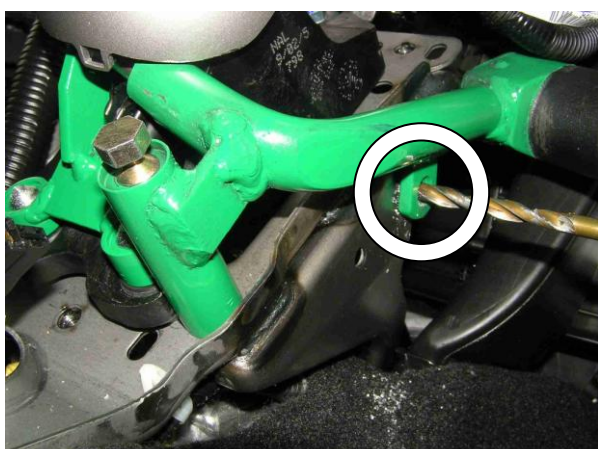
Просверлить отверстие в стойке селектора сквозь отверстие в лапке замка
