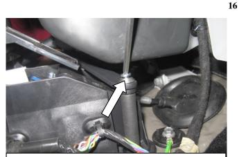
Закрепите правую точку крепления болтом (поз. 7) с шайбой (поз. 8)
