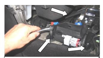
Установите деталь (поз. 3) на левые точки крепления селектора, а деталь (поз. 4) на правую
