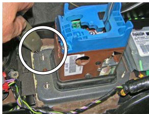
Удалить мешающую установку замка звукоизоляцию
