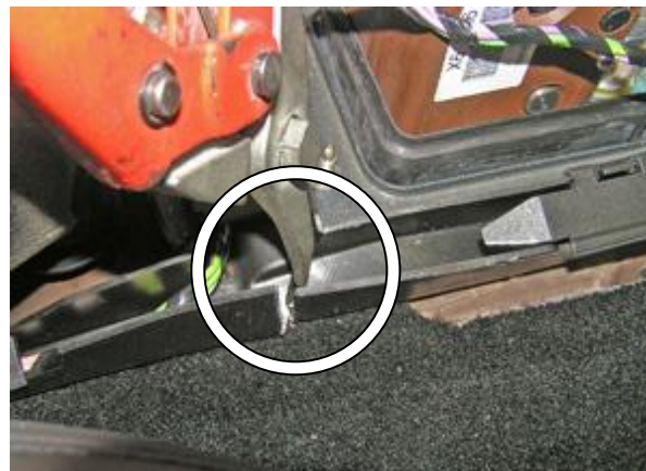
Удалить мешающий установке замка пластик
