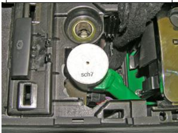
Разметить, используя разметочный шаблон, отверстие в крышке под корпус замка
