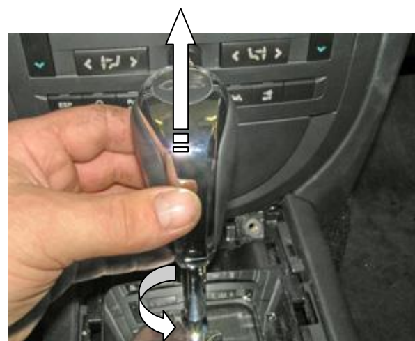
Открутить и снять рукоятку рычага переключения передач
