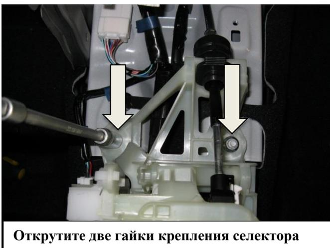
Открутите две гайки крепления селектора
