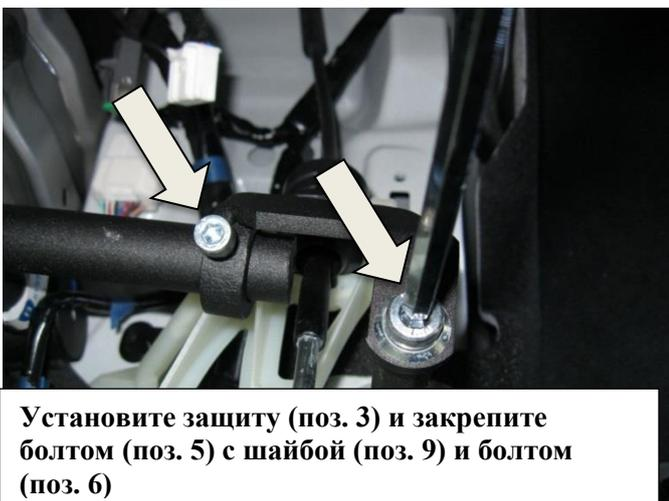
Установите защиту (поз. 3) и закрепите болтом (поз. 5) с шайбой (поз. 9) и болтом (поз. 6)
