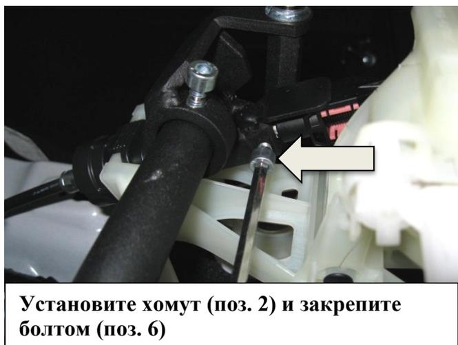
Установите хомут (поз. 2) и закрепите болтом (поз. 6)
