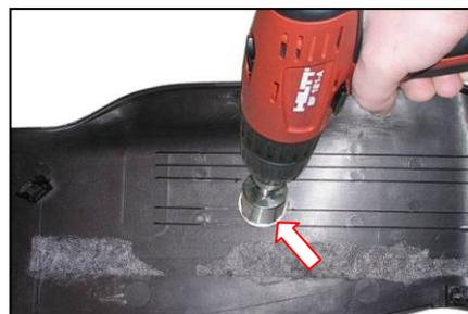
Расширить отверстие до 32 мм.
