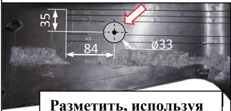
Разметить, используя разметочный шаблон, отверстие в консоли под корпус замка
