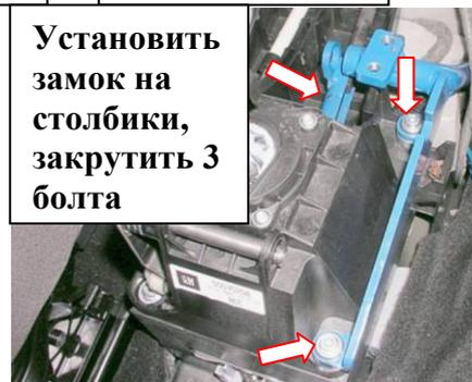
Установить замок на столбике, закрутить 3 болта
