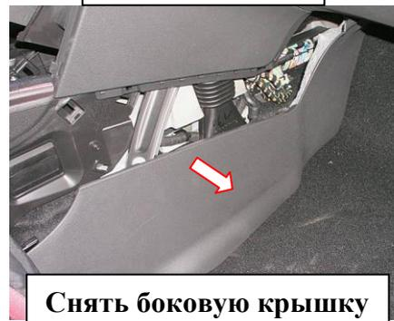
Снять боковую крышку
