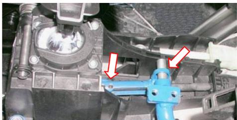
Установить хомут на тягу, зафиксировать винтом, перевести рычаг в положение «R», произвести блокировку, отрегулировать положение хомута на тяге, сорвать винт
