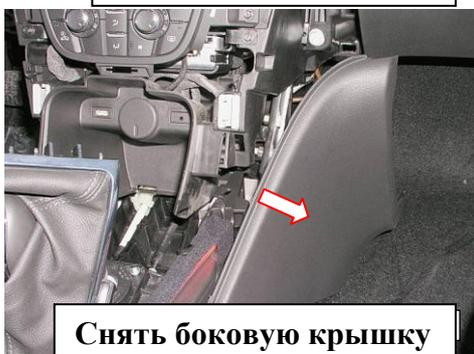
Снять боковую крышку
