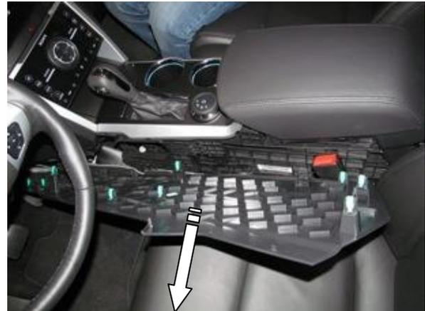
Снять боковую крышку
