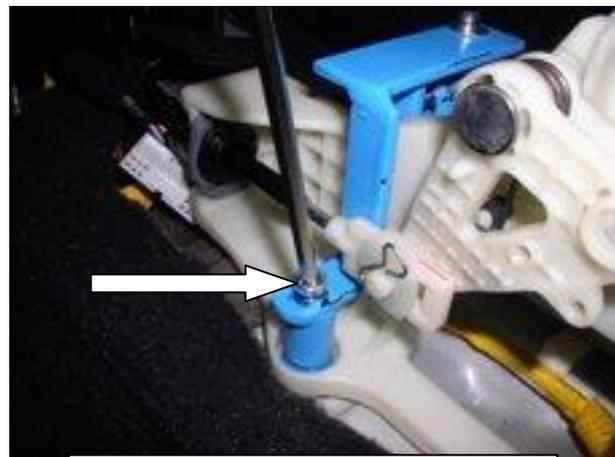
Зафиксировать лапку защиты на столбике срывным болтом
