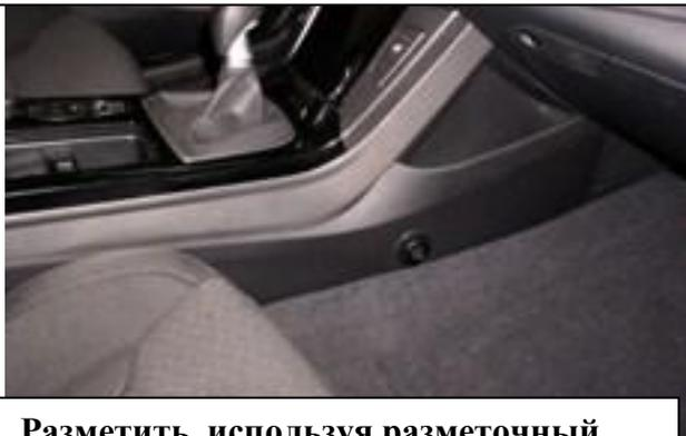
Разметить, используя разметочный шаблон, просверлить и расширить до 32 мм. отверстие в консоли под корпус замка, установить консоль на место
