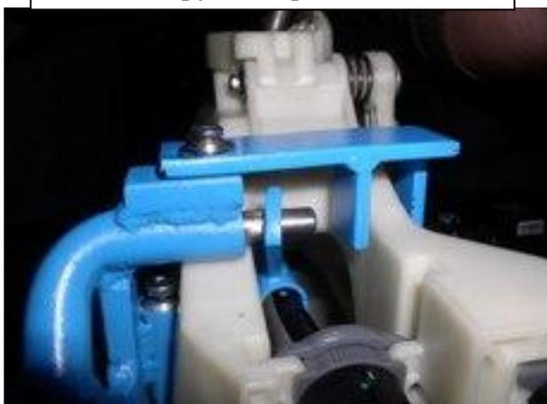
Перевести рычаг переключения передач в положение «R», произвести блокировку, при необходимости отрегулировать положение хомута на тяге, сорвать винты
