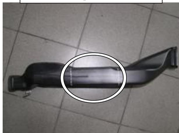
Разметить и отрезать часть воздуховода, загерметизировать отверстие скотчем, установить воздуховод на место
