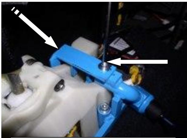
Установить защиту тяги на полку замка, закрутить срывной болт
