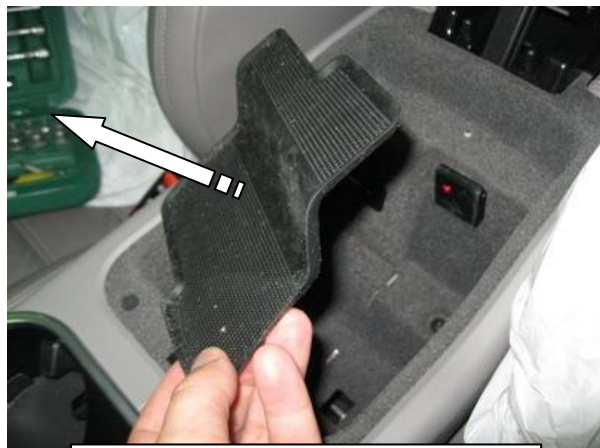
Поднять подлокотник, снять декоративную прокладку
