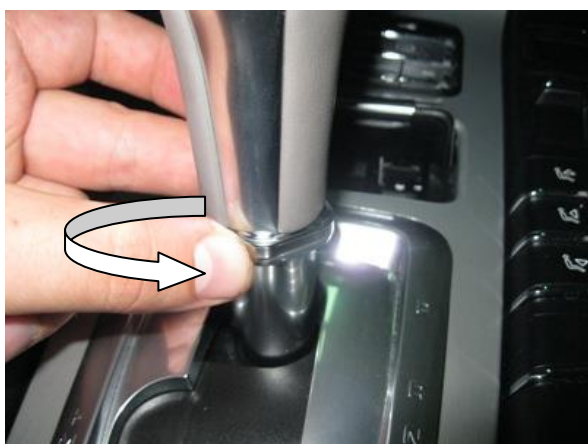
Открутить стопорное кольцо рукоятки
