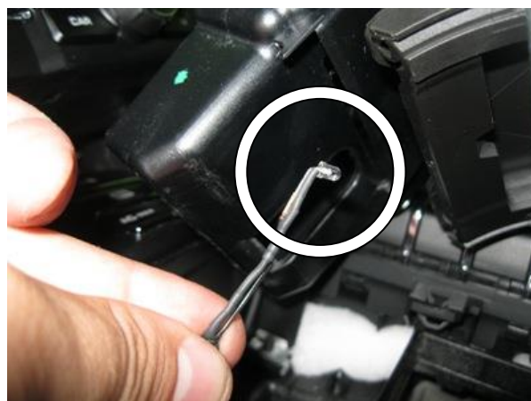
Осторожно отсоединить светодиод
