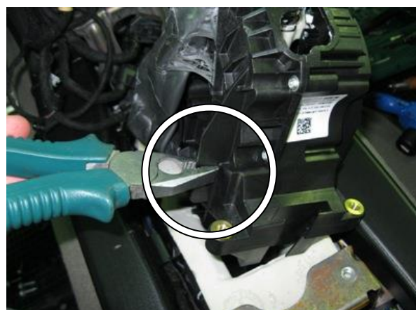
Удалить мешающее ребро жёсткости селектора
