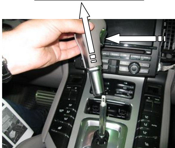
Снять рукоятку рычага, не нажимая кнопку!!!
