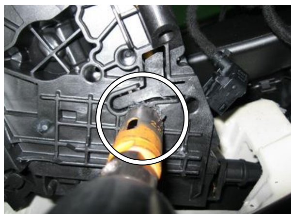
Снять шаблон, расширить отверстие до 22 мм.
