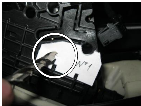
Просверлить отверстие 6 мм. по разметке
