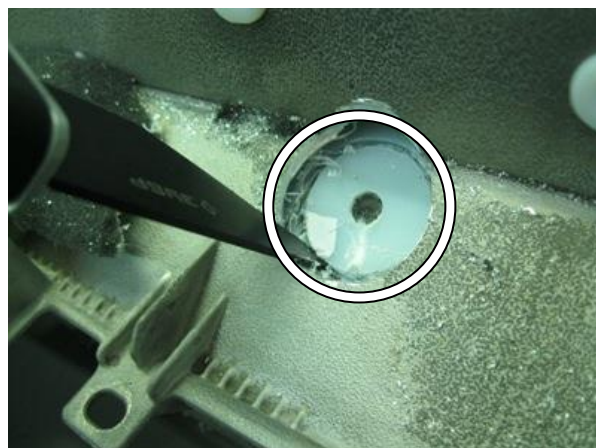
Снять шаблон, проделать ножом отверстие в наружном пластике консоли
