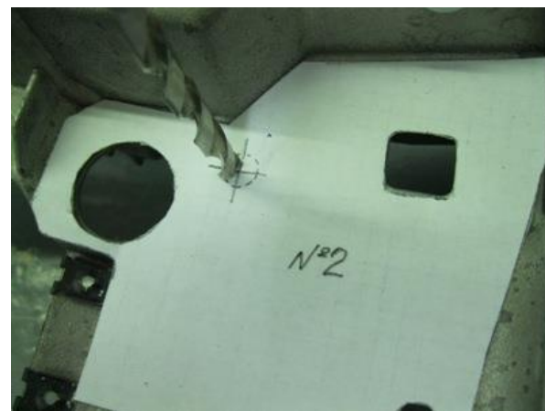
Просверлить отверстие 9 мм. по разметке
