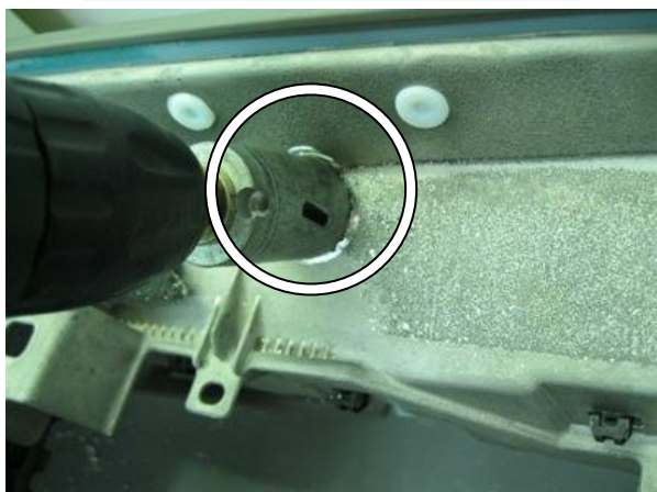
Снять шаблон, расширить отверстие до 32 мм.
