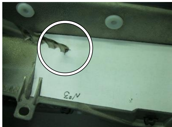
Просверлить отверстие 6 мм. по разметке
