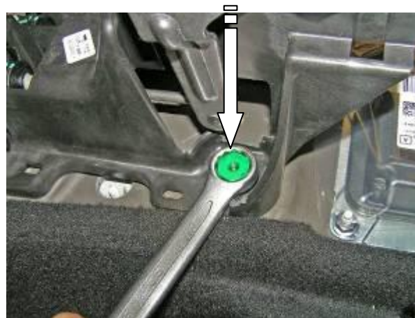
Установить шестигранный столбик на шпильку
