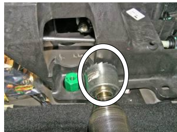
Удалить мешающий пластик селектора
