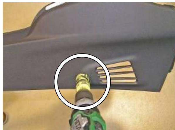
Расширить отверстие до 32 мм.
