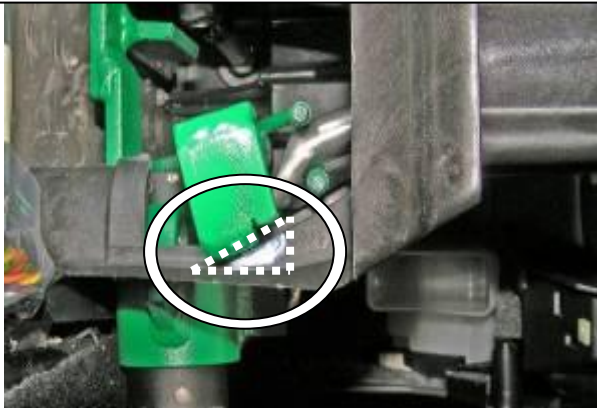
Удалить мешающий пластик селектора
