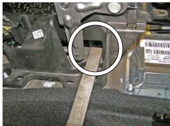
Удалить мешающий пластик селектора
