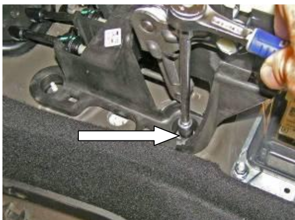
Открутить штатную гайку селектора
