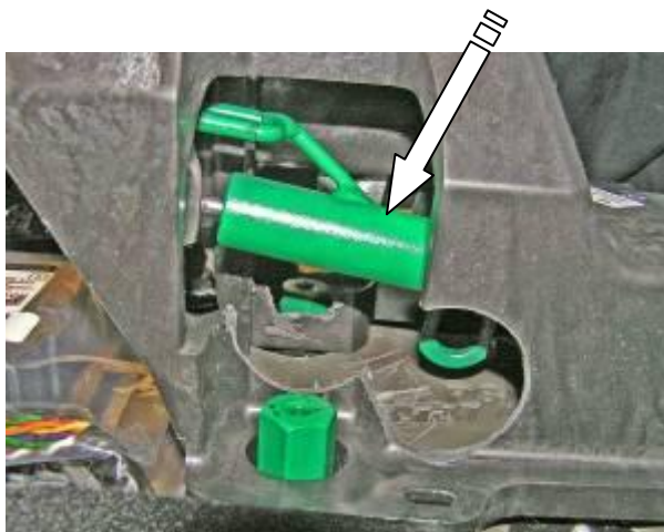
Установить хомут на тягу, зафиксировать 2 винтами (не срывать!!!)
