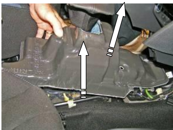
Снять звукоизоляционный кожух, снять кабель под кожухом
