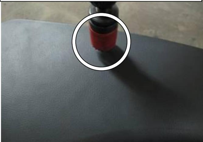
Просверлить и расширить отверстие
