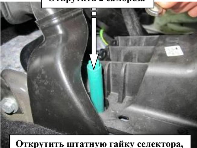
Открутить штатную гайку селектора, установить шестигранный столбик 75 мм. на шпильку
