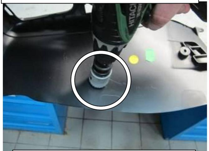
Просверлить и расширить отверстие
