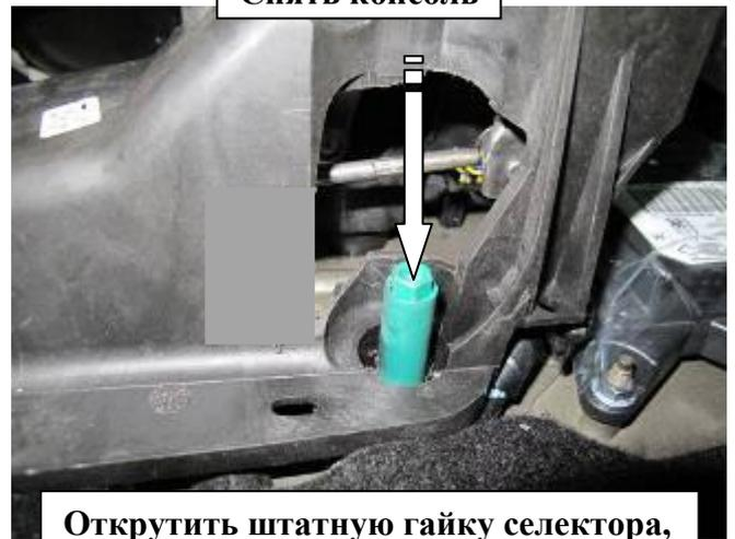
Открутить штатную гайку селектора, установить шестигранный столбик 45 мм. на шпильку
