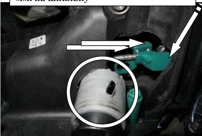
Удалить мешающий установке замка пластик селектора
